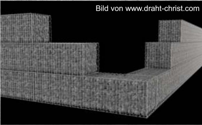
**Gabionenwand** – Es gibt vorgefertigte Korbenelemente entsprechend der Hanghöhe, die in passender Breite ausgewählt und befüllt werden. Da die Gabionenwände sicher verankert werden müssen, ist bei dieser Methode das Fundament von zentraler Bedeutung. Auch hier muss vor der Errichtung einer Gabionenwand über 1 m Höhe ein Fachmann, z. B. ein Statiker, zu Rate gezogen werden. Informationen über unsere Gabionensteine finden Sie in unserem Katalog auf S. 40.
